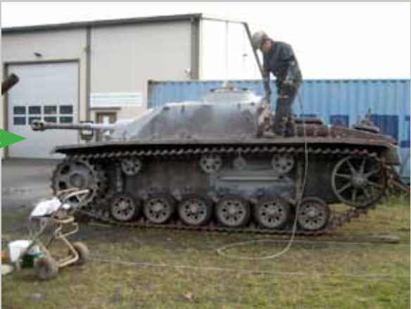
Hiekkapuhallus poisti vanhan pintaruosteen.
