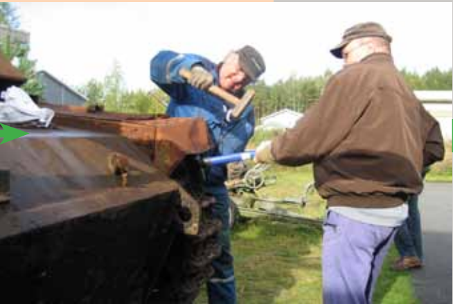
Lokasuojan oikaisu toteutettiin perinteisin menetelmin.
