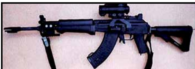
Rynnäkkökivääri 7,62 RK 62 M. M-versiossa on teleskooppipäätä, punapistetähtäin / kiväärikaukoputki / valonvahvistintähtäin ja lisäadapteri taktista valaisinta / laserosoitinta varten.
