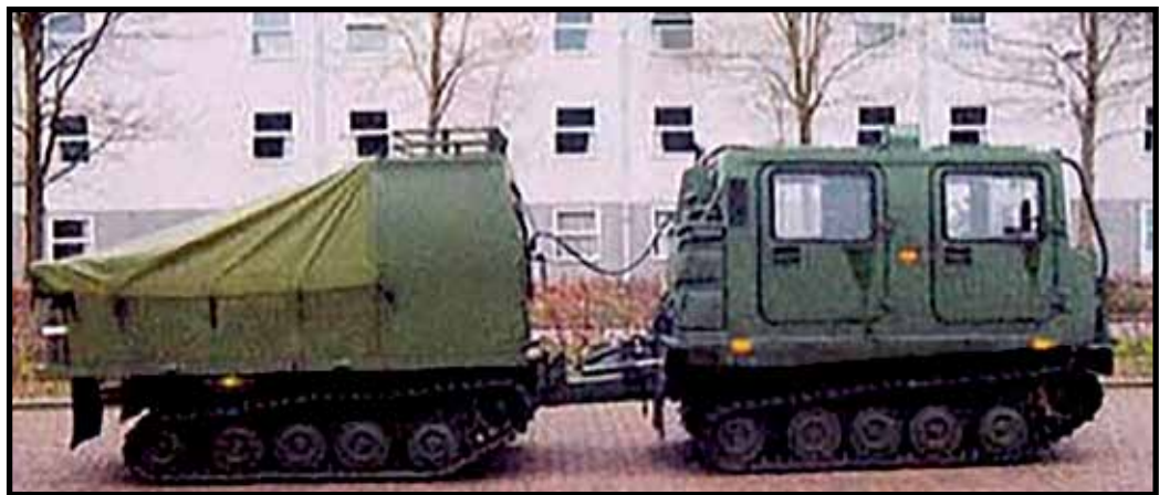
Kranaatinheitintela-ajoneuvo. Perävaunussa on ampumavalmis 81 mm:n kranaatinheitin.
