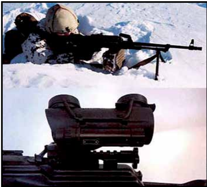
Konekivääri 7,62 KK PKM. Alakuvassa PKM:n optinen tähtäin Kiväärikaukoputki 2014, jonka tilalle voidaan vaihtaa VV3X-valonvahvistintähtäin.
