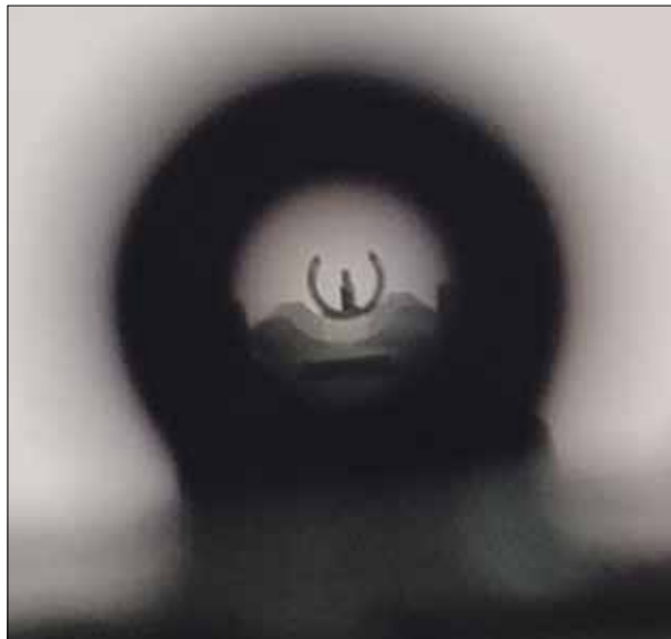
Reserviläiskiväärin oikea, keskitetty tähtäinten linjaus. Kuvalähde: Pasi Oikarinen 2021. MPK:n 7.62x39 reserviläiskivääri: ohje aseiden käsittelyyn ja kenttähuoltopurkuun.
