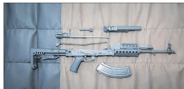
MPK-kivääri. Valmistaja Dasan Machineries Etelä-Korea, Kaliiperi 7.62 x 39, Aseen paino 3,1 kg, Pituus 895 mm. (Kuva ja Tiedot Reserviläinen)
