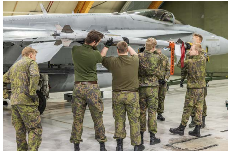
Ohjuksen asentamista LTEK.
