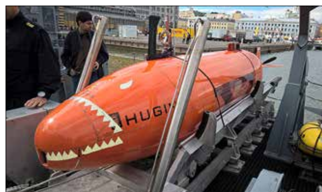
Aluksen päämiinanetsintäsensori, itsenäisesti toimiva Hugin-robotti.
