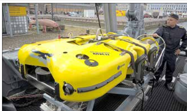
Saabin valmistama Double Eagle MkII on kauko-ohjattava robotti, jolla pystyy tekemään yksinkertaisia vedenalaisia töitä.
