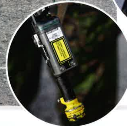
ASEEN LÄHETIN. Lähettää laserkeilan, jonka vastapuolen ilmaisimet havaitsevat osumana tai ohilaukauksena. Vaatii toimiakseen aseentilapääntöä ja rekyylin, joka syntyy paukkupatruunan murskaamisen ansiosta.
