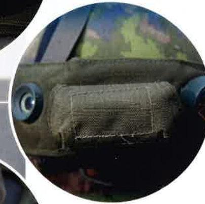
PALAUTEYKSIKKÖ. Ääni kertoo varusmiehelle ohilaukauksesta tai osumasta. Osuma saattaa tehdä aseentilapäisesti toimintakyvyttömäksi. Kuvassa alempana on osumiin reagoiva liivin ilmaisin.
