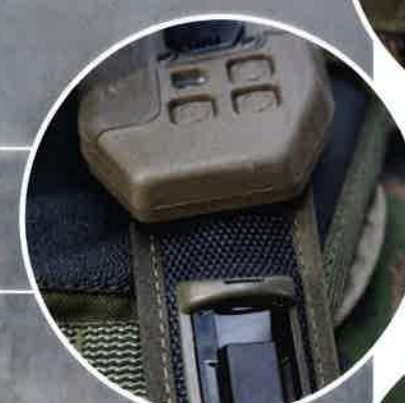
PALAUTEYKSIKKÖ. Ääni kertoo varusmiehelle ohilaukauksesta tai osumasta. Osuma saattaa tehdä aseentilapäisesti toimintakyvyttömäksi. Kuvassa alempana on osumiin reagoiva liivin ilmaisin.
