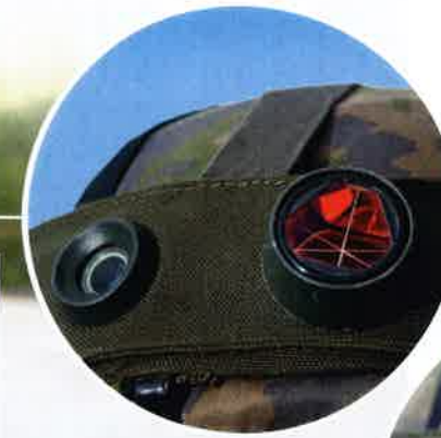
ILMAISIMET (kuvassa vasemmalla). Kahdeksan kappaletta liiveissä ja kuusi kypärässä. Vastaanottavat vastapuolen aseiden lähettämiä laserkeiloja ja välittävät tiedot liivin keskusyksikölle.
